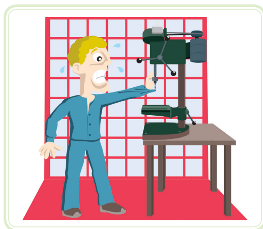
Figura 3.8: Ponto de agarramento em uma furadeira de bancada
