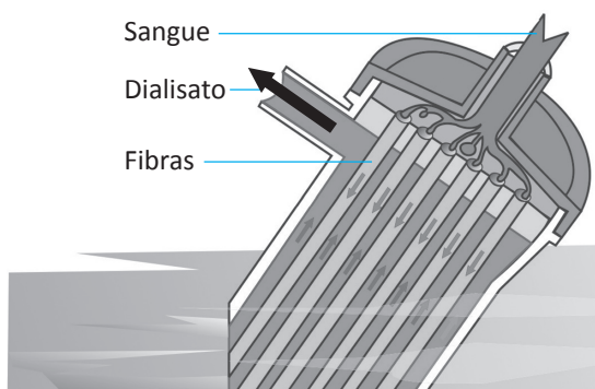
Esquema: Dialisador do tipo capilar
