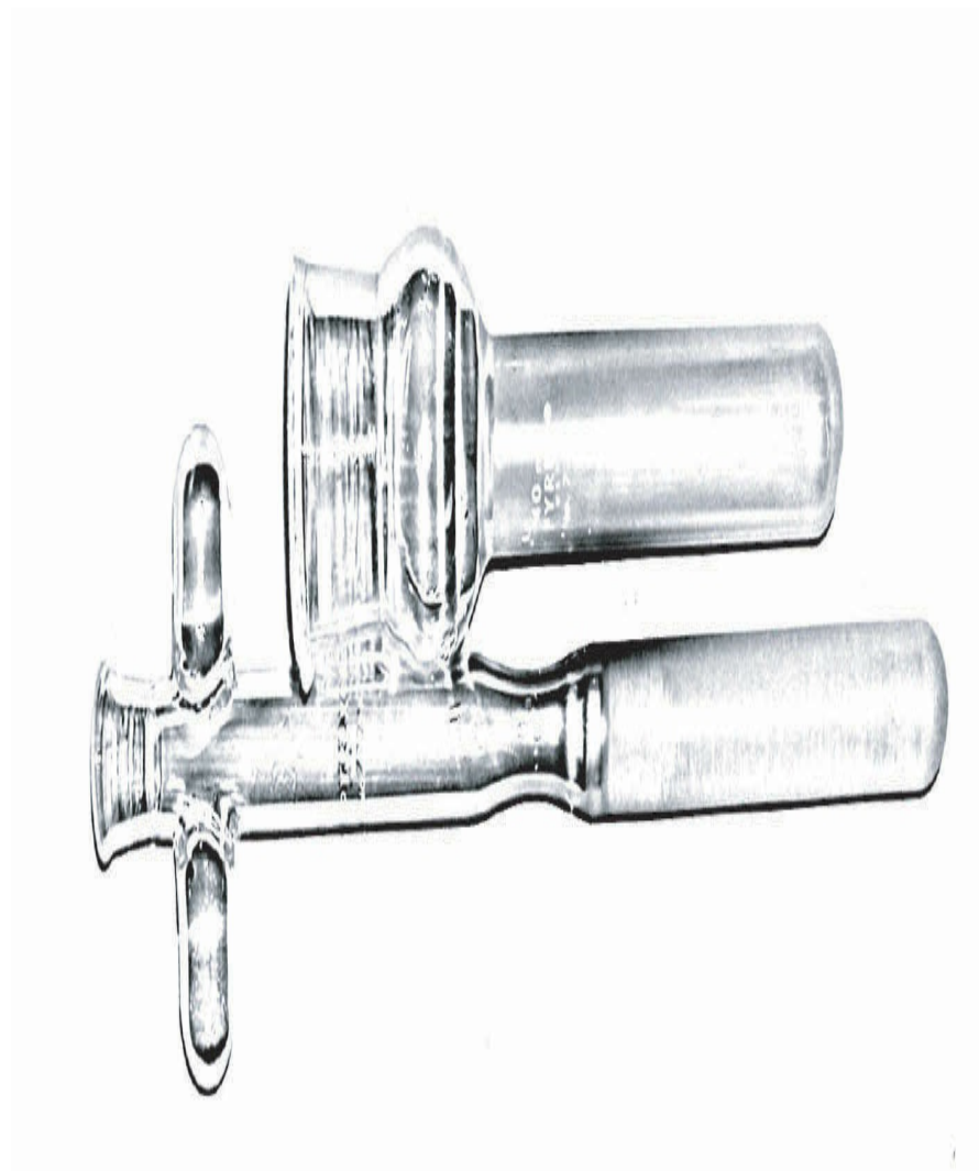
Figura 2.1 Triturador de tecidos de vidro, usado como um pilão cilíndrico para homogeneizar tecido cerebral.
