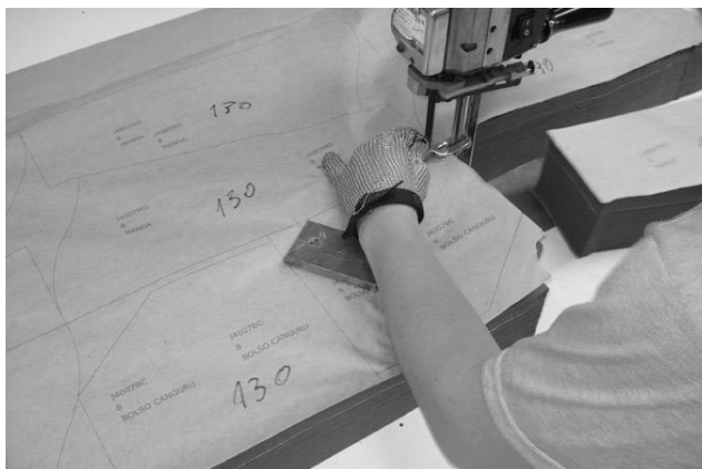
Figura 1 – Operador de enfiesto realizando o corte dos moldes das roupas com várias camadas de tecido sobrepostas
