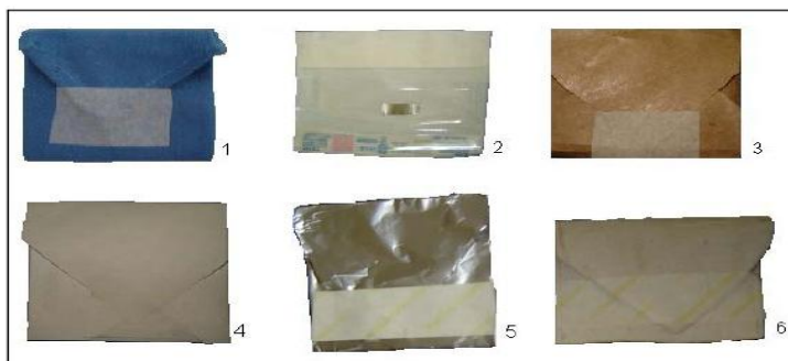
Figura 2: Embalagens dos corpos de prova que compunham a amostra. 1. Tecido tipo Brim; 2. Papel grau cirúrgico; 3. Papel Kraft; 4. Papel crepado; 5. Lâmina de alumínio; 6. Tecido de algodão cru (campo duplo).
