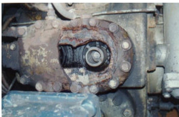
Figuras 10 e 11 – Tampa do compressor rompida
