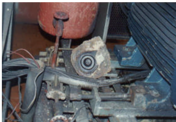
Figuras 10 e 11 – Tampa do compressor rompida
