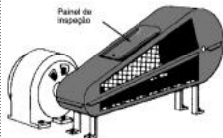
9 PROTEÇÃO OU BARREIRA FIXA EM UM JOGO DE POLIAS E CORREIAS
