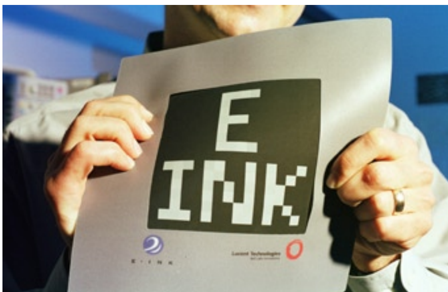
Protótipo desenvolvido pela Lucent Technologies e E Ink Corp. Produzido com transistores de materiais plásticos.
