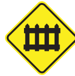
A-40 Passagem de nível com barreira
