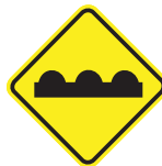
A-17 Pista irregular
