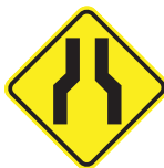
A-21a Estreitamento de pista ao centro
