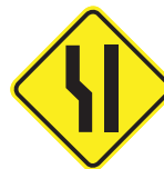
A-21d Alargamento de pista à esquerda
