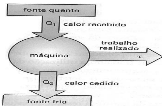
FIGURA 1: Esquema de máquina térmica. A segunda lei garante que há perda de calor na realização de trabalho.
